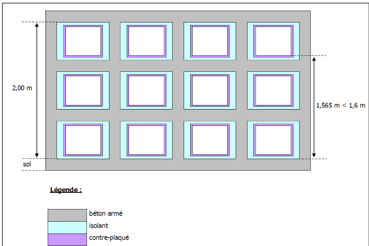
Figure 18 : Schéma de la configuration des cellules de stockage
